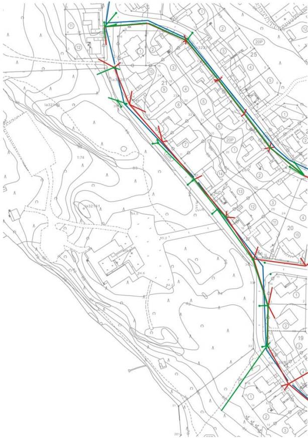
Kuva 18 (vasen). Ote verkostokartasta, sininen = vesijohto, punainen = viemäri, vihreä = huolevesi.
