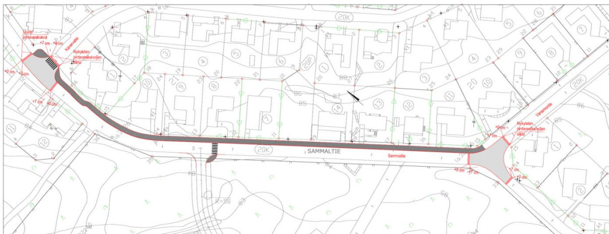
Kuva 31. Sammaltien yleissuunnitelmatasoinen katusuunnitelma välillä Vanamontie – Kanervatie, FCG 5.6.2014. Suunnitelmaa ei ole päivitetty.
