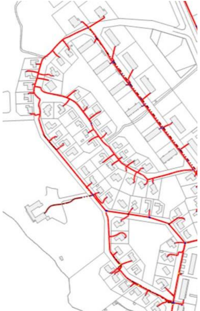
Kuva 18 (vasen). Ote verkostokartasta, sininen = vesijohto, punainen = viemäri, vihreä = huolevesi.
